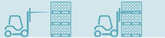
2. Pode elevar a paleta da sua extremidade ao colocar os garfos nos orifícios da paleta. Neste caso, necessita de garfos de paleta mais largos com um comprimento mínimo de 1,70m. Certifique-se de que os garfos estão totalmente debaixo da primeira das duas estruturas em madeira antes de elevar.
