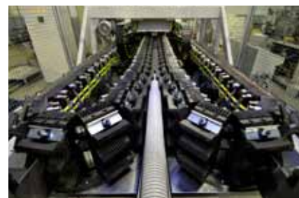
Παραγωγή διπλού δομημένου τοιχώματος σωλήνων
